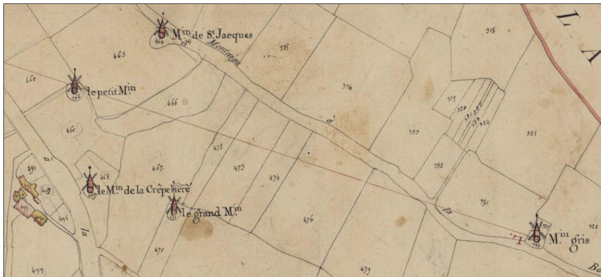
Les cinq moulins à vent du "faubourg Saint-Jacques" de Montaigu, sur le plan cadastral de 1814 (environ 670 x 310 m). Le dessin y représentant le "Grand Moulin" montre qu'il a servi de point de triangulation lors du levé de ce plan cadastral.
